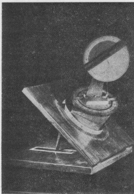
Ryc. 8. Torquetum Frankona z Polski z r. 1284, pierwszy przykład tego zasadniczego w średnio-wieczu przyrządu obserwacyjnego.
