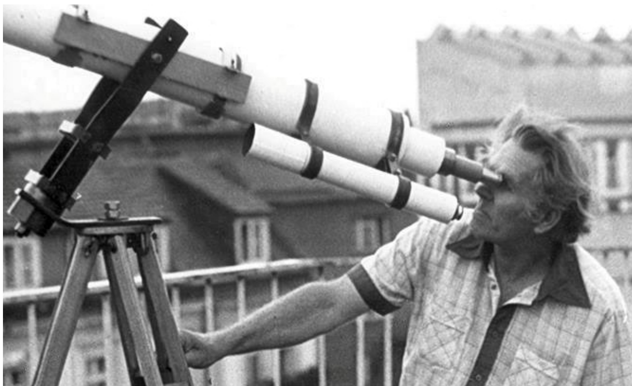
Pan Janusz pozuje przy własnoręcznie wykonanej lunecie. Własnej roboty jest też statyw i uchwyt paralaktyczny. Jedyne soczewki na obiektyw i okular są wykonane fabrycznie.
